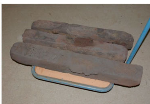
Foto 3, rechts) De ijzerbaren vóór de eerste, oppervlakkige schoonmaak: een ruw uiterlijk, hier en daar een rode kleuring, barsten en sporen houtskool
