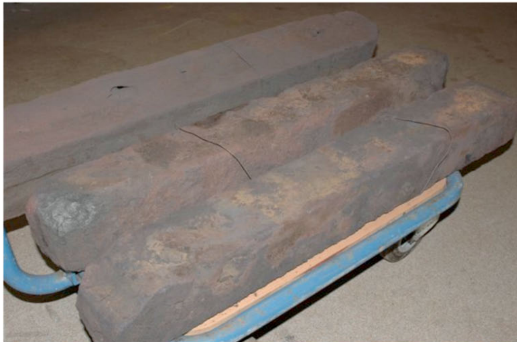
Foto 6) De baren na het stralen. Het ijzer is donkergrijs met nog slechts een dun laagje, dat iets rood tekt.
