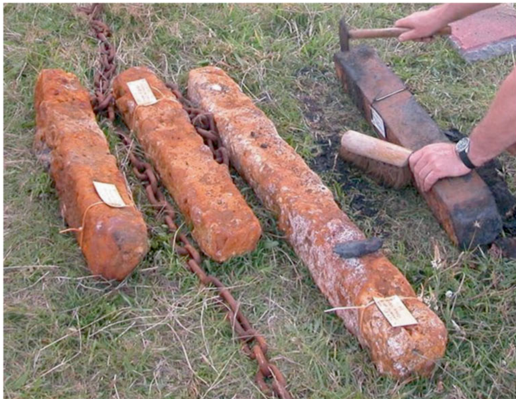
Foto 1) De ijzerbaren, zoals ze eruitzagen na berging: met een laagje concretie. Ofschoon de concretie redelijk loskwam, ging dat toch niet 100% zonder beschadiging van het object, dus is verder gekozen voor gloeien.
