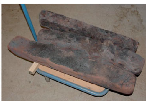
Foto 2, links) Het ijzer en hout direct na opening van de oven. Het hout is verkoold, maar niet verast.
