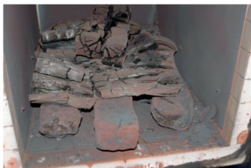
Foto 2, links) Het ijzer en hout direct na opening van de oven. Het hout is verkoold, maar niet verast.
